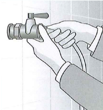
Ausblasen des Staubes aus der Leitung, bzw. Ausblasen des Dichtmittels
