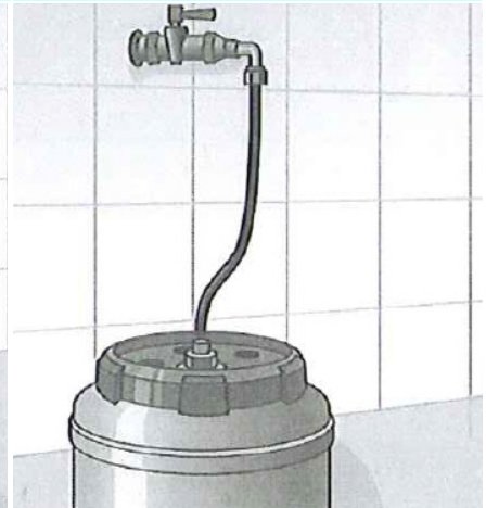
Entleeren der Leitung in den Auffangbehälter
