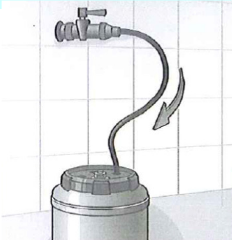
Entlüften der Leitung
