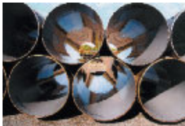
Recubrimiento interior de PROTEGOL® 130 HT aplicado por procedimiento en línea en tubos de 56" con espesor de capa de 600 µm
