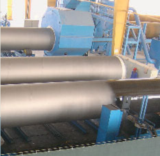
Recubrimiento en línea de tubos con diferentes diámetros nominales: unidad de chorreado/zona intermedia de acomodo/unidad de recubrimiento para tubos individuales
