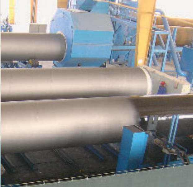
Revestimento Online de tubos com diferentes diâmetros nominais: unidade de aplicação por jacto/zona de armazenamento intermédio/estação de revestimento para tubos individuais
