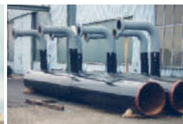
Componentes de centrais eléctricas: revestimento exterior de um distribuidor
