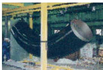
Componentes de pipelines: revestimento exterior de um cotovelo
