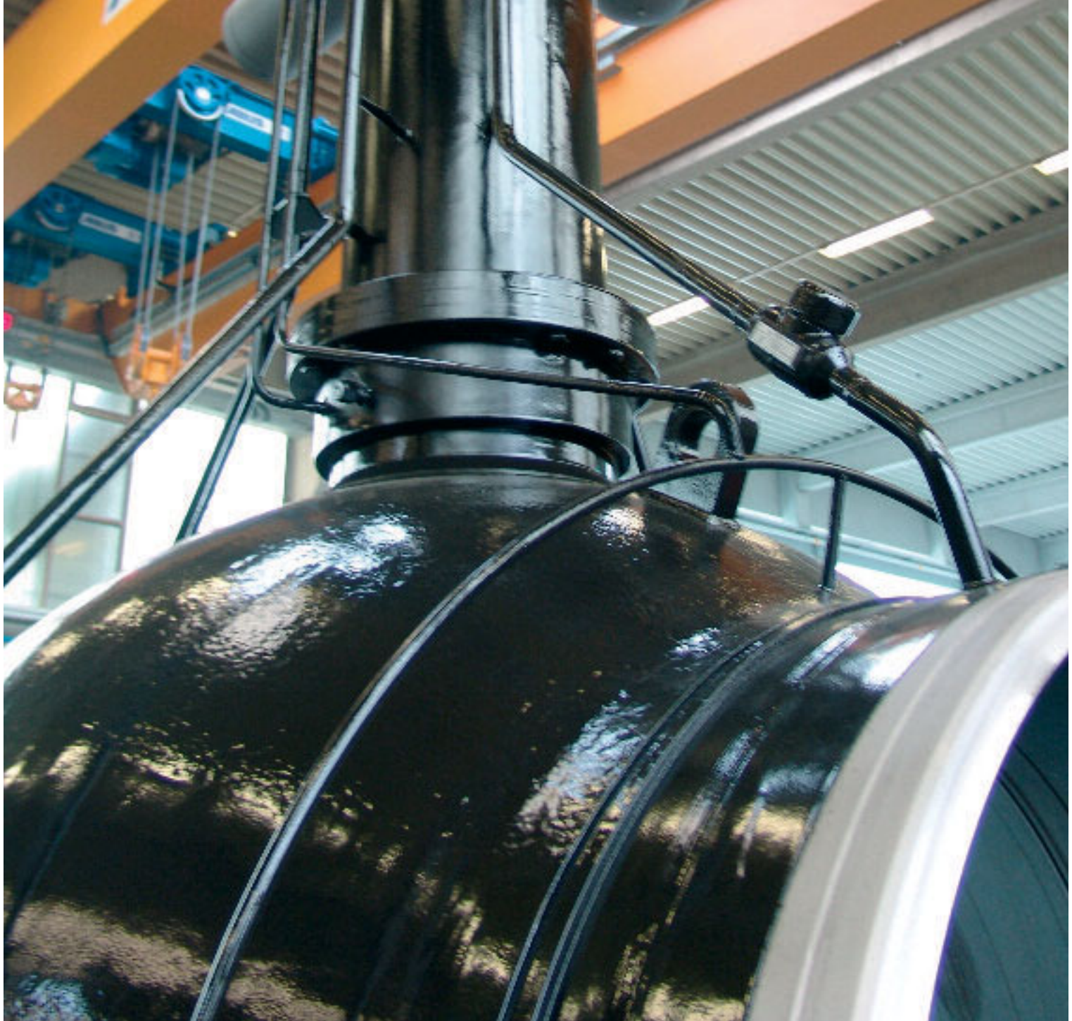
Guarnições para gás: revestimento exterior de uma torneira de esfera de 56" – revestimento com PROTEGOL®UR 32-55 com espessura de revestimento > 2 mm para a indústria de tubulações/pipelines
