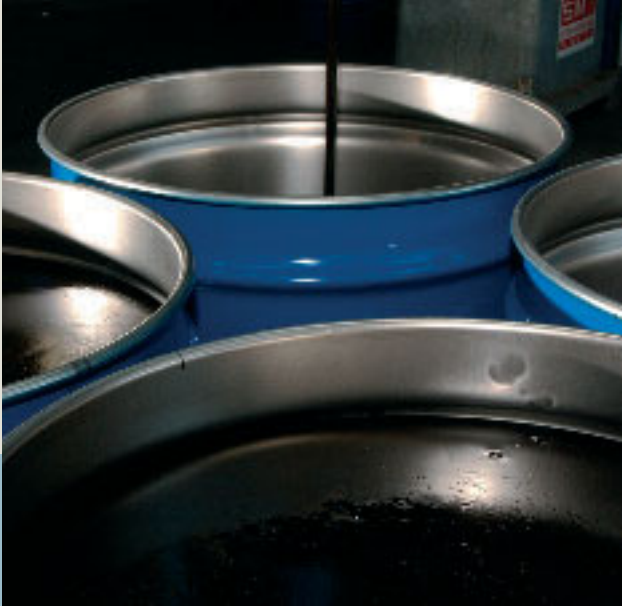
Processo de enchimento de componentes de PROTEGOL® em barris descartáveis de 200 l. Outras variantes de envasilhamento em embalagens descartáveis de 30 l ou em recipientes descartáveis ou reutilizáveis de 1.000 l.
