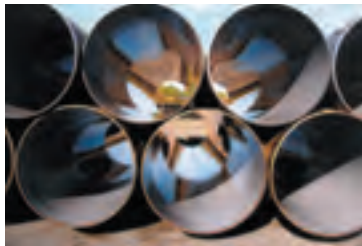
Im Online-Verfahren applizierte Innenbeschichtung von 56" Rohren mit PROTEGOL® EP-Beschichtung 130 HT in einer Schichtstärke von 600 µm
