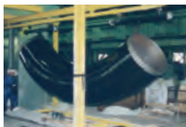
Pipelinekomponenten: Außenbeschichtung eines Rohrbogens
