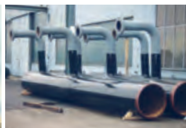
Kraftwerkskomponenten: Außenbeschichtung eines Verteilers
